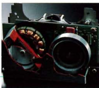
■ Motore a trazione diretta per un basso Wow & Flutter
