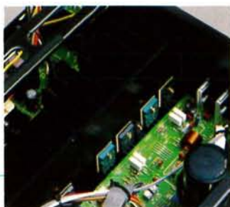
■ Lo stadio finale MOSFET conferisce al KA-7050R una elevata linearità in una ampia gamma di frequenza
